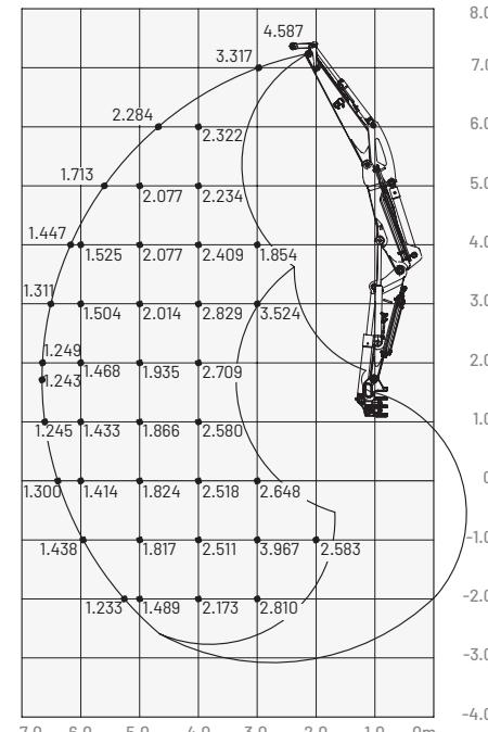
Opterećenja u dijagramima (lijevo) su unutar 87 % hidrauličkog kapaciteta dizanja i unutar 75 % kapaciteta prevrtanja.
