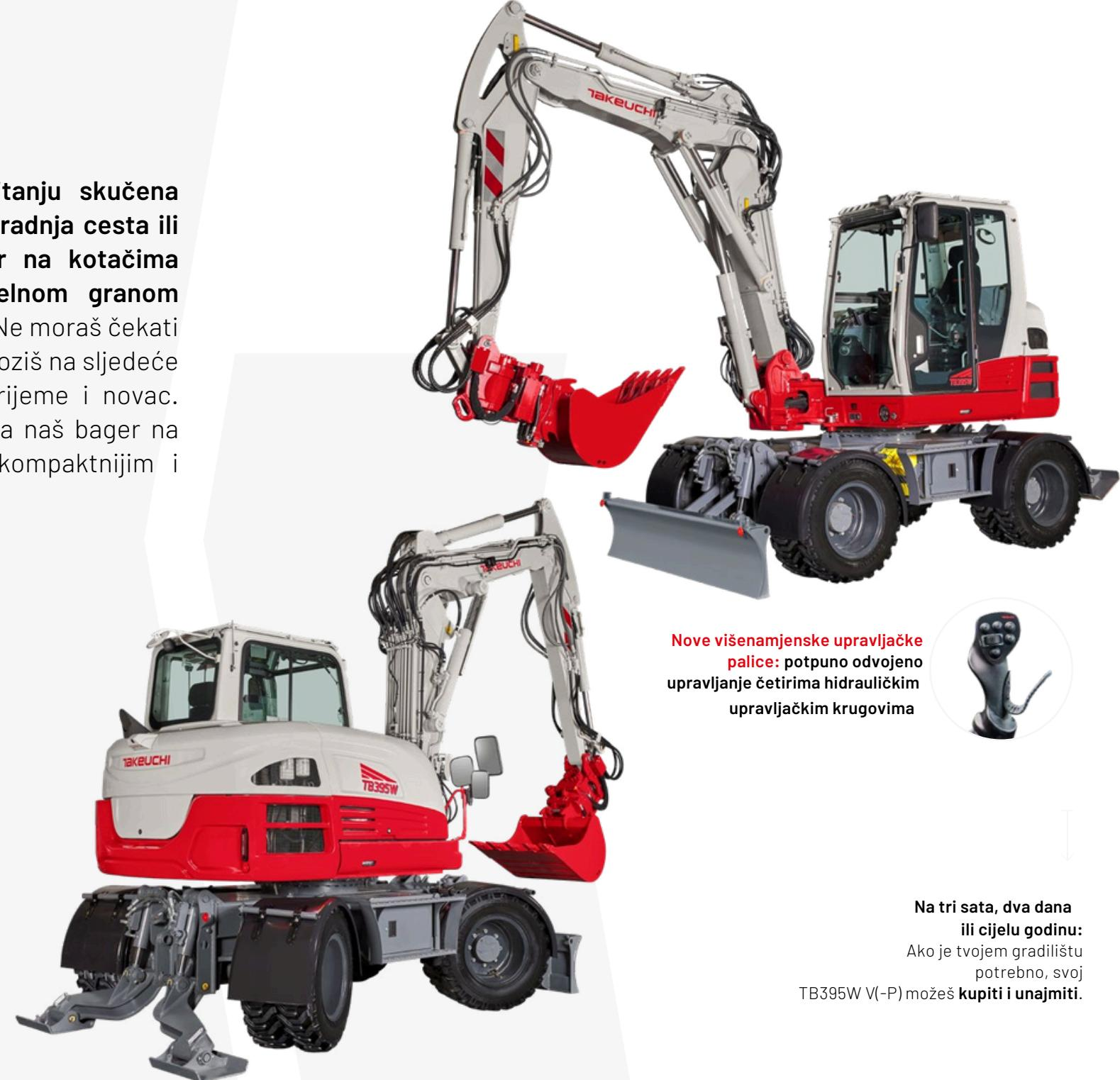
**Nove višenamjenske upravljačke palice:** potpuno odvojeno upravljanje četirima hidrauličkim upravljačkim krugovima
