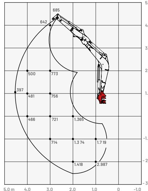
Opterećenja u dijagramu su unutar 87 % hidrauličkog kapaciteta dizanja i unutar 75 % kapaciteta prevrtanja.
