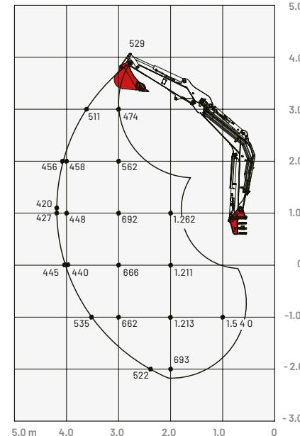
Opterećenja u dijagramu su unutar 87 % hidrauličkog kapaciteta dizanja i unutar 75 % kapaciteta prevrtanja.
